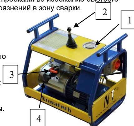
1. Манометр, 2. Рычаг управления 3. Рычаг спускового клапана, 4. Регулировка клапана DBD
