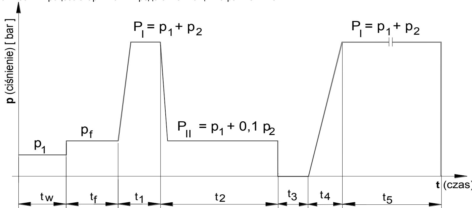
Рис. 2. Циклограмма правильного процесса сварки
