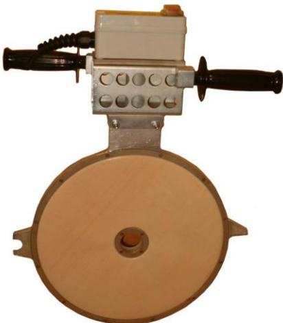
Плита служит для нагревания торцов свариваемых элементов. Она состоит из 2-х алюминиевых дисков, 2-х покрытий из PTFE ткани (тефлон), 2-х комплектов колец, крепящих ткань, нагревательного элемента, ручки и провода питания.
