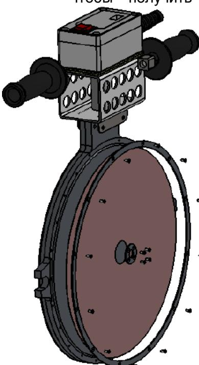
Перед каждой сваркой поверхность нагревательной плиты следует очистить и промыть соответствующим чистящим средством для ткани PTFE (напр. этанолом);
