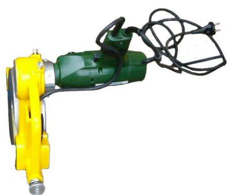
Рубанок оборудован защитным механизмом блокировки, предотвращающим случайное приведение в действие вне прижимного устройства. Включение устройства возможно лишь после его закрепления на направляющих стержнях пережимного устройства.
