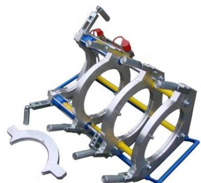
При сварке фасонных деталей, напр. отводов или тройников, можно снять конечный сегмент устройства, выкручивая крепежные болты, и установить соединяемый элемент на одном держателе. Прижимное устройство UMSN подключено к гидросистеме с помощью гибких гидравлических шлангов Ø6 x 3000 через наконечники быстрого соединения, и может работать с гидравлическими питателями производства Nowatech типов UHRB, UHRN, UHEN.
