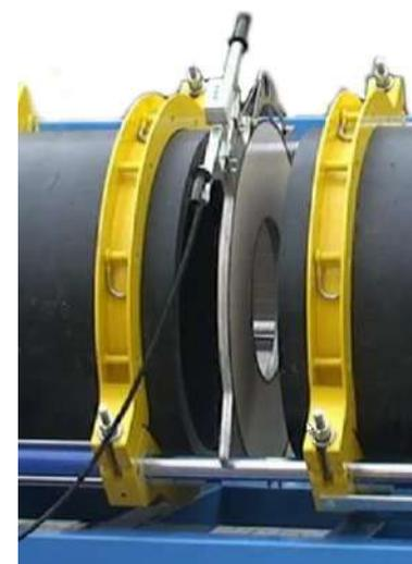
Регулятор размещенный на гидравлическом питателе. **Управление регулятором** производится при помощи 3-х управляющих кнопок: „—“, „Nastawa“, „+“ („—“, „Установка“, „+“). После включения нагревательной плиты на дисплее сперва появится имеющаяся температура, а затем в соответствии с записанной в памяти установкой температуры начинается процесс нагрева.
